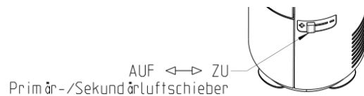
Fig. 4: Regolazione della levetta dell'aria
